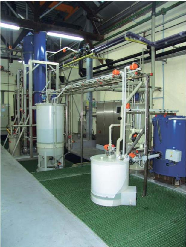
Kristallisation  $\text{HNO}_3 + \text{HF} + \text{ZrF}$
