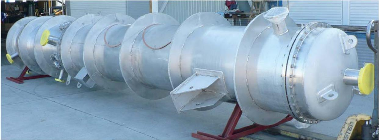
Fallfilmverdampfer Methanol Biodiesel 1150kW
