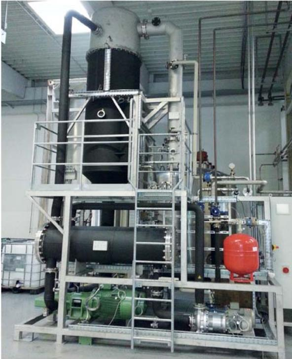
Zwangsumlaufverdampfer Entwässerung von Hydrauliköl. Viskosität bis zu 20.000 mPa s.
