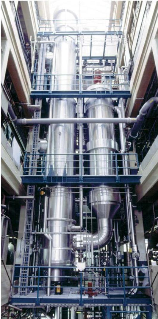
Rektifizieranlage mit Dünnschichtverdampfer
