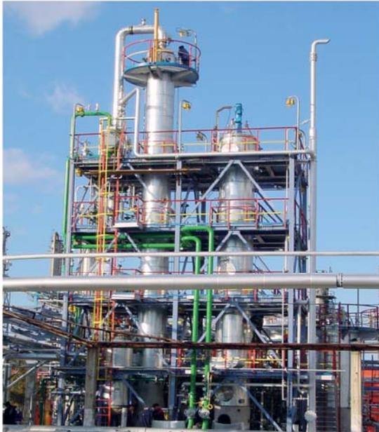
Gerührte Kolonne und Lösemittelrückgewinnung
