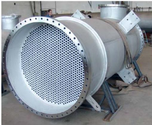
Dampferzeuger div. Lösemittel 2350kW
