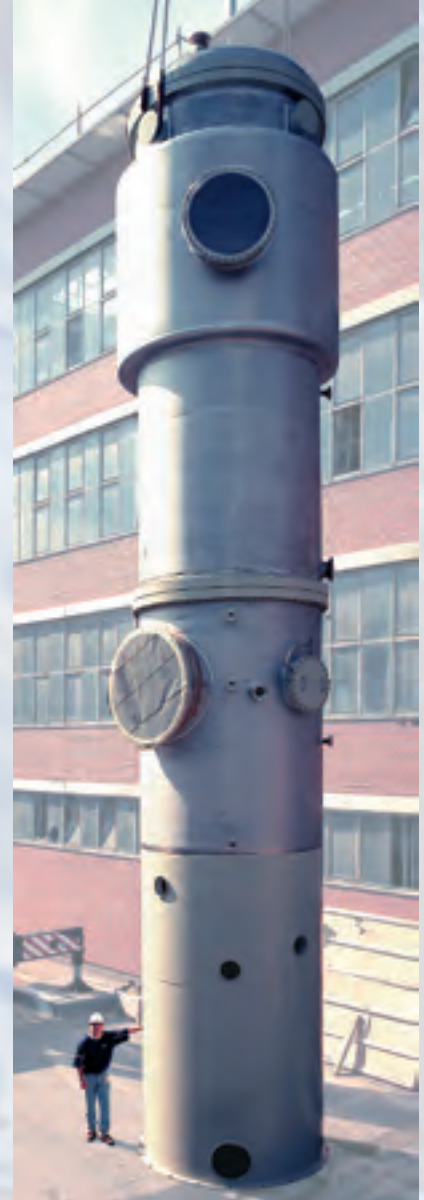
Fallfilm-Verdampfer 2400 m 2 , Verdampferleistung 20 t/h mit mechanischer Brüdenverdichtung
