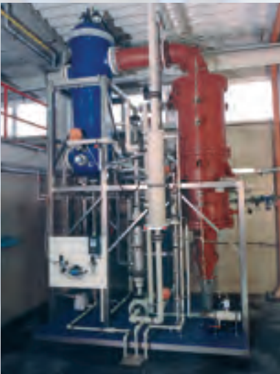
Zwangsumlauf-Verdampfer für die Aufkonzentration von Flusssäure/Schwefelsäure
