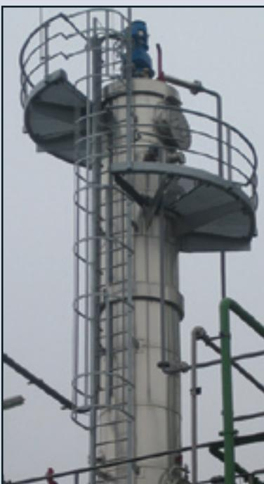
La colonne à mélangeurs décanteurs superposés a la même fonction qu'une batterie de mélangeurs décanteurs ; comme dans un mélangeur décanteur, il y a une séparation complète des phases à chaque étage.
