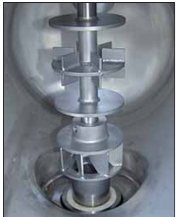
Pump-Mix-Turbine aus Mixer-Settler Typ MST 300
