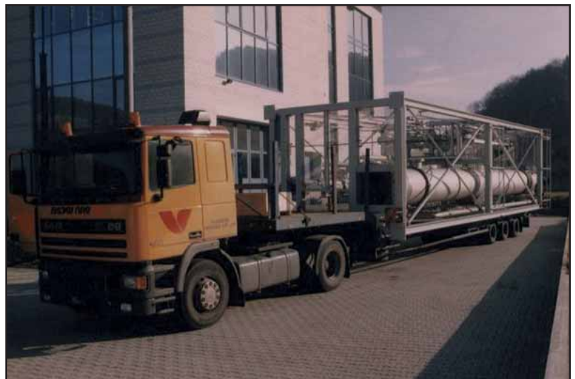
Transport einer vormontierten Skid-Unit
