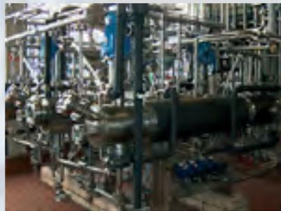
Mélangeur-décanteur type MST
