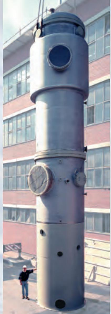
Evaporateur à film tombant 2400 m<sup>2</sup>, capacité d'évaporation 20 t/h avec compression mécanique des vapeurs
