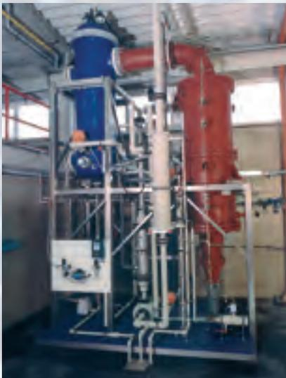
Évaporateur à circulation forcée destiné à la concentration d'acide fluorhydrique/acidé sulfurique
