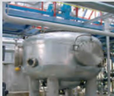
Mélangeur-décanteur à 3 étages type MSV
